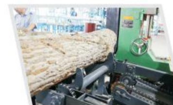
气动推木，一键简单操作 Pneumatic log push,
